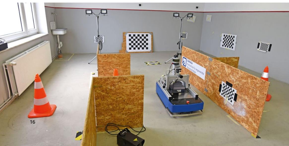
Ein Forschungsteam erprobt die Führung eines fahrerlosen Transportfahrzeuges in einer Testumgebung. Für den Warentransport auf der Straße muss vor allem die Verkehrssicherheit gewährleistet werden.
